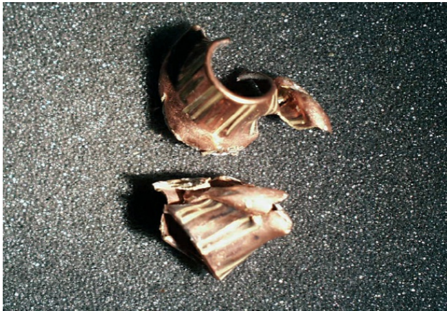
Abb. 32: Auswertefähig erhaltene Splitter des Geschossmantels
