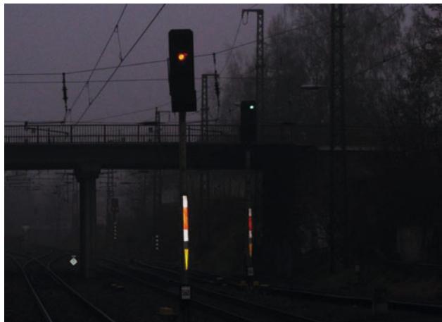
Abb. 4.49 Durch Retroreflexion hervortretende Signaltafeln und Mastschilder bei Dämmerung
