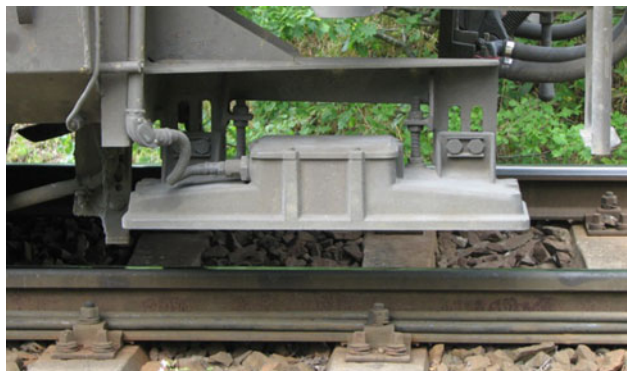
Abb. 7.6 Fahrzeugmagnet an einem Triebfahrzeug
