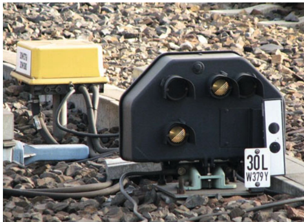
Abb. 4.69 Ra 12 zeigendes Sperrsignal mit weißem Mastschild mit zwei schwarzen Punkten
