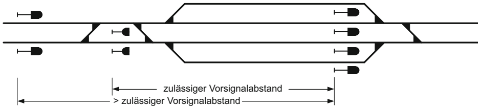
Abb. 5.28 Verschiedene Zuordnungen von Vor- und Hauptsignal
