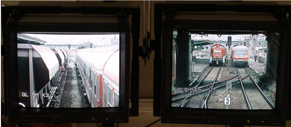
Abb. 4.8 Monitore in einem Stellwerk zur Fernbeobachtung von Gleisabschnitten
