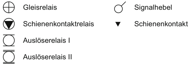
Abb. 4.21 Verwendete Schaltzeichen an der Isolierten Schiene
