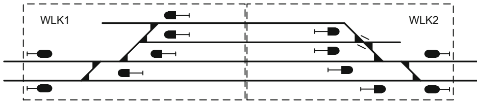
Abb. 5.16 Beispiel für Weichenlaufketten (WLK) in einem Bahnhof
