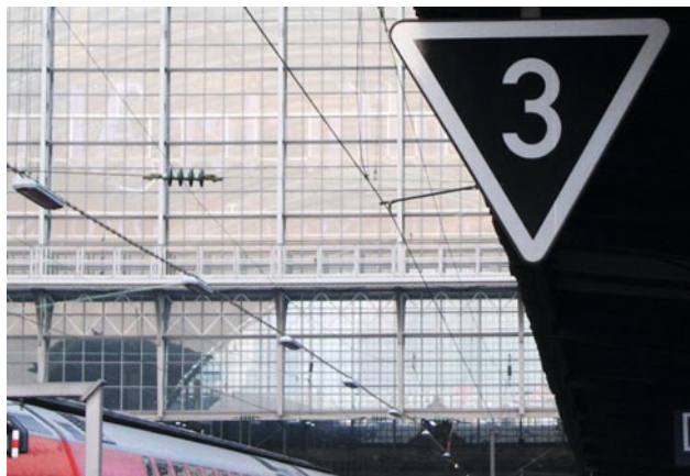
Abb. 10.20 Gestufte Geschwindigkeitssignalisierung mittels Zs 3 Formsignal am Bahnsteigdach eines Stumpfgleises
