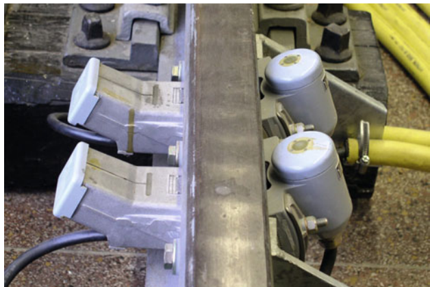
Abb. 4.18 Realisierung eines doppelten Schienenkontaktes
