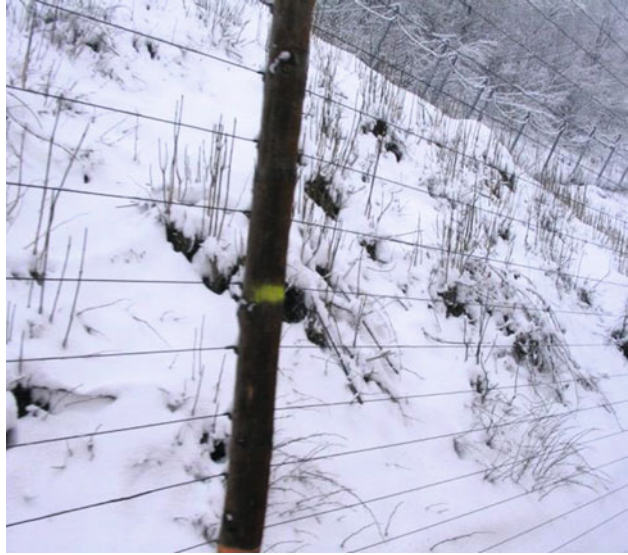
Abb. 4.6 Anlage zur Erkennung von Erdbeben und Lawinen mittels Reißdrähten
