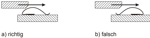
Bild 4.5 Einbau unsymmetrischer Kontaktstreifen
