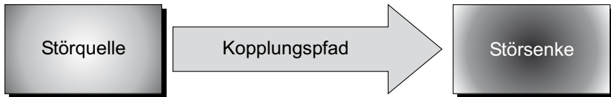
Bild 1.1 Beeinflussungsmodell der Elektromagnetischen Verträglichkeit
