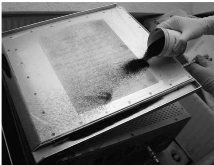
Abb. 12: Elektrostatische Oberflächenprüfung: Sichtbarmachen von Durchdruckspuren (zerstörungsfrei)
